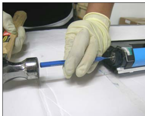
46. Usar un saca-pernos y martillo para golpear desde el lado sin engranajes y soltar el eje del cilindro.
