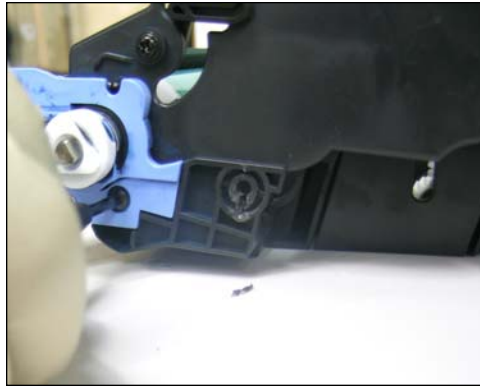
45. Sacar los dos tornillos restantes de la manija de instalación del cartucho como se muestra.
