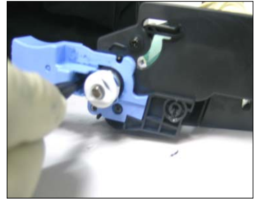
45. Sacar los dos tornillos restantes de la manija de instalación del cartucho como se muestra.
