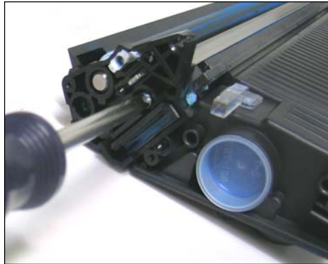
21. Ahora desmontar el soporte del rodillo sacando los dos tornillos como se muestra.
