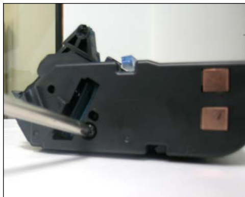
16. Sacar los dos tornillos de lado opuesto como se muestra.
