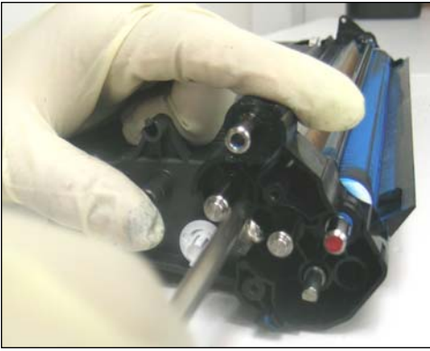
18. Desmontar la otra placa del lado donde estaban los engranajes sacando los dos tornillos que la sujetan.
