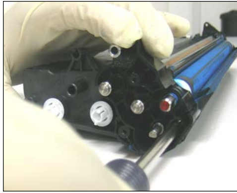
18. Desmontar la otra placa del lado donde estaban los engranajes sacando los dos tornillos que la sujetan.
