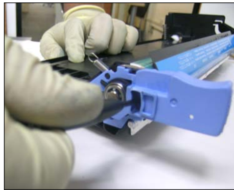
40. Para desmontar la unidad de cilindro primero sacar los tornillos de la manija azul del lado sin engranajes.
