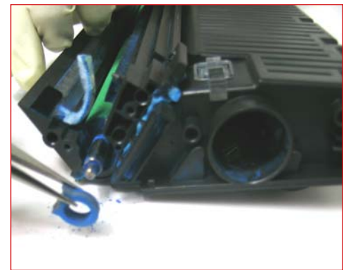
32. Retirar el buje de goma que mantiene el rodillo de alimentación en su lugar..
