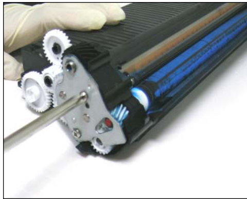
12. Sacar los tornillos niquelados de la placa lateral.
