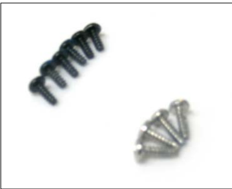
39. Para el montaje existen tornillos diferentes. Seis pequeños color negro (dos para cuchilla dosificadora, dos para el soporte y dos para la placa lateral) y cuatro largos niquelados (dos para la placa metálica y dos para el soporte del rodillo).
