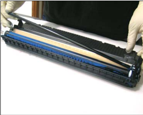
20. Una vez retirada la placa, el rodillo de carga se podrá soltar para su extracción.
