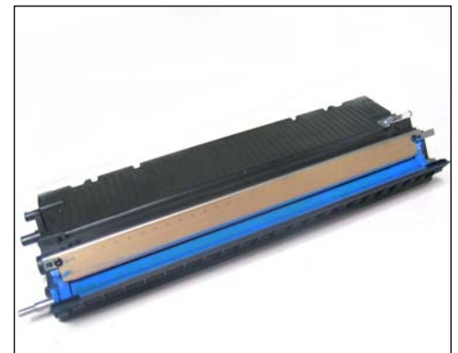
24. Vista frontal del deposito de toner sin rodillos de revelación y de carga.
