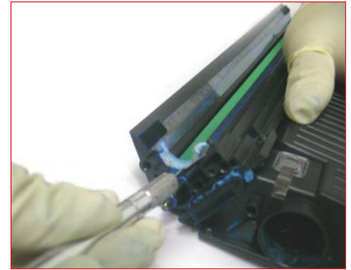
29. Con un estilete separar cuidadosamente las felpas de sello del rodillo magnético.
